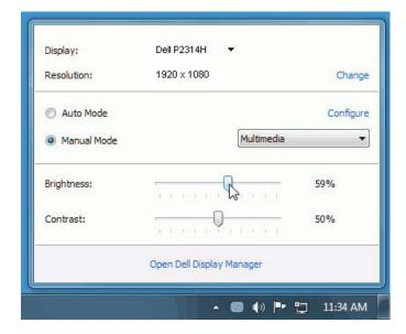
La boîte de dialoque Réglage rapide permet également d'accéder à l'interface utilisateur avancée de Dell Display Manager qui est utilisée pour ajuster les fonctions de base, configurer le Mode auto et accéder aux autres fonctions.
